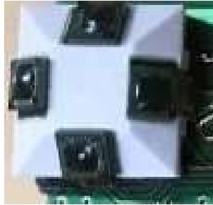
ピラミッド型の3軸素子
