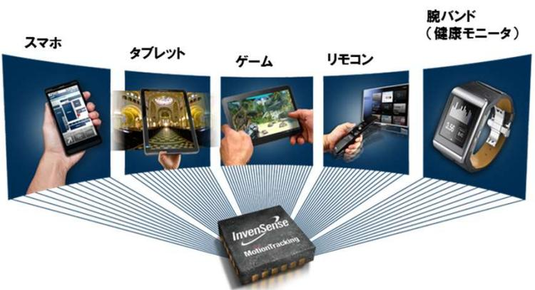
図3 MEMSジャイロを内蔵した9軸Fusionセンサ サイズ: 4×4×1mm
