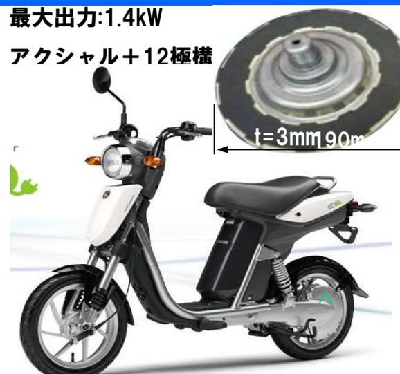
図2-14) 電動バイク用モータ アクシャル型+1.4Kw
